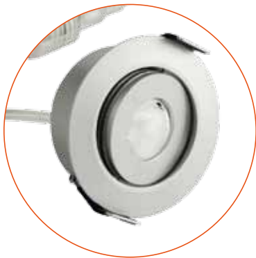
REGULUS - LED Spot Einstellbar von +/- 13° Ausschnitt: Ø 43 mm 380lm
